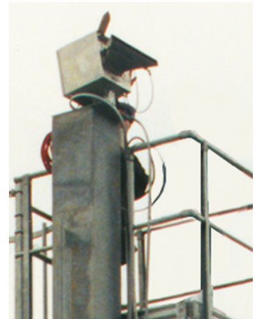
防护罩内的线扫描仪安装在塔顶。
