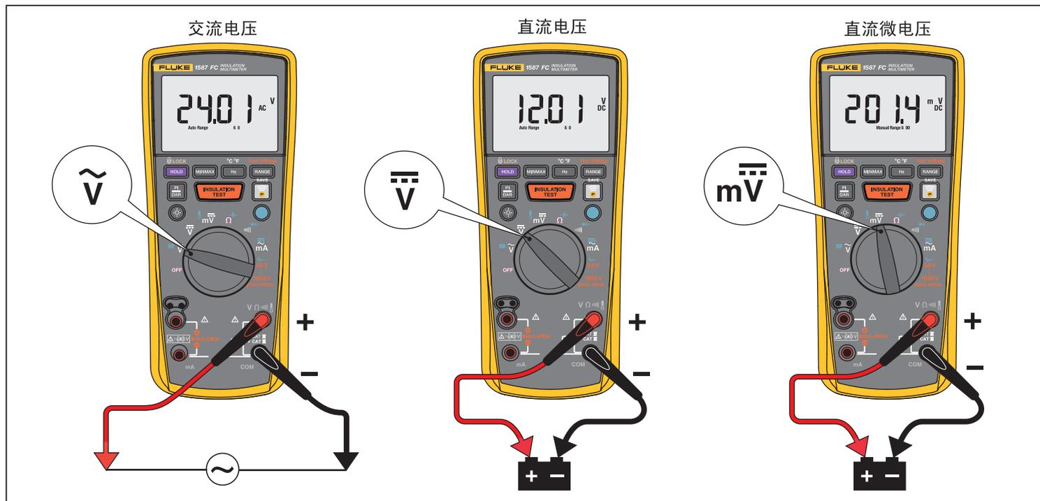
图 2. 测量交流和直流电压
