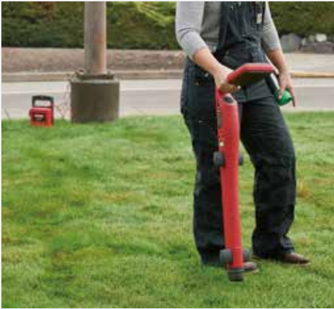
将发射器直接与测试线连接，跟踪单个设施
