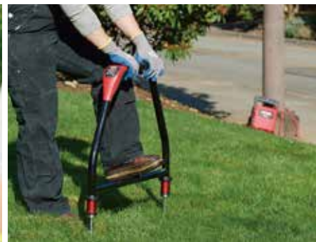
利用AF-600和UAT-600发射器确定故障位置
