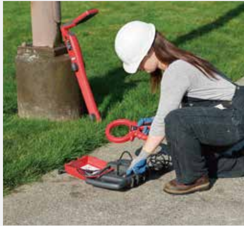
发送器将根据插入的附件自动更改模式
