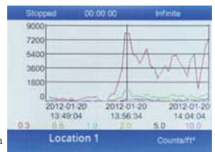
15 分钟采集到的 0.3 - 10 \mu\text{m} 粒子数据图
