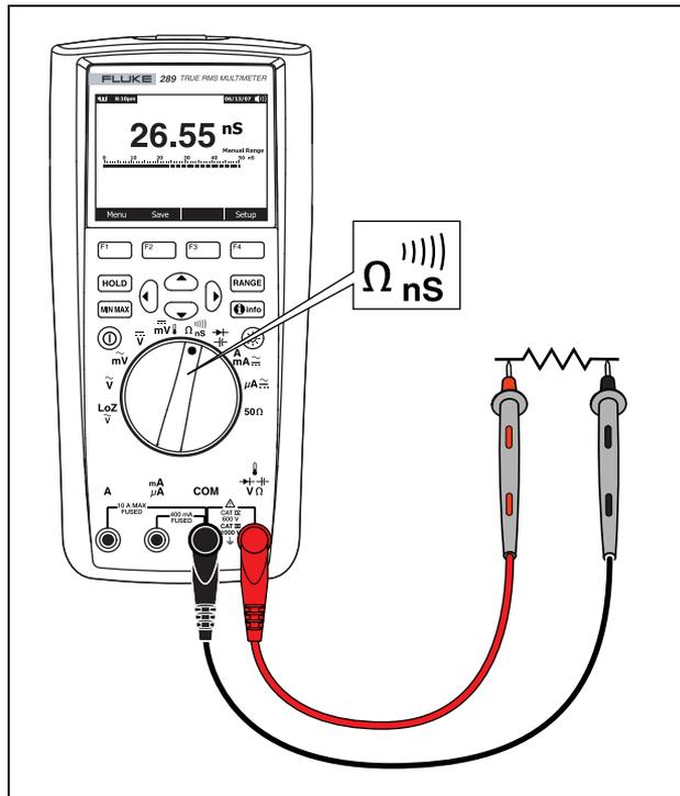
图 18. 电导测量
