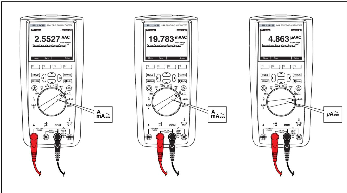
图 21. 电流测量设置
